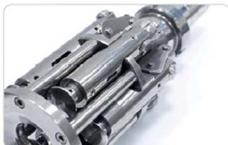
Funzionamento a pulsante e distribuzione dei tappi manuale. La macchina è dotata di una TESTA A 4 RULLI (per un solo formato tappo) intercambiabile.
