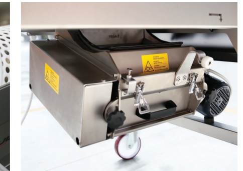
Pigiatrice estraibile con sgancio. Removable crusher by release.
